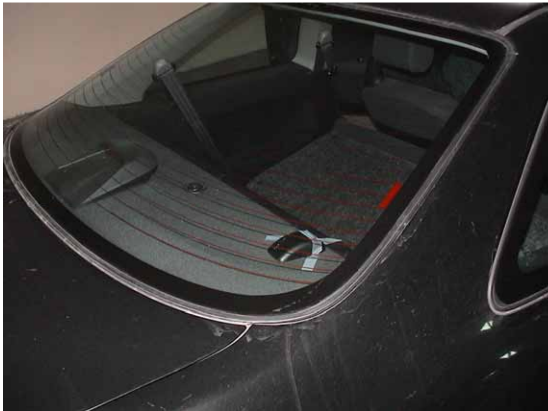
写真4 GPS アンテナの設置
