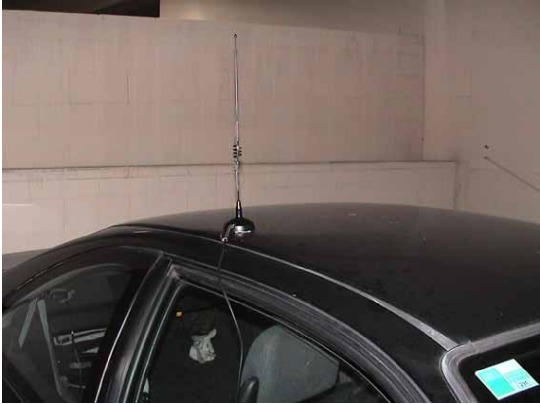
写真3 データ送信用アンテナの設置
